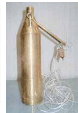
Slika 3. Specijalna posuda za uzimanje uzoraka goriva iz rezervoara, izrađena prema standardu BAS EN ISO 3170 (proizvođač- Metalurški institut "Kemal Kapetanović" Zenica)
