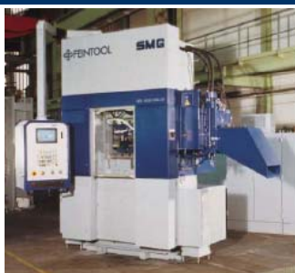
Izgled prese trostrukog dejstva za fino prosjecanje
