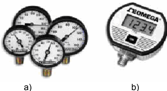
Slika 10.22. Bourdonov manometar: a) analogni (s kazaljkom), mjerni opsezi 0-1 bar, 0-50 bar, klasa tačnosti 3%, b) digitalni; mjerni opsezi 0-1 bar, od 0-100 bar, klasa tačnosti 0,25 %, mjerni signal 4-20 mA
