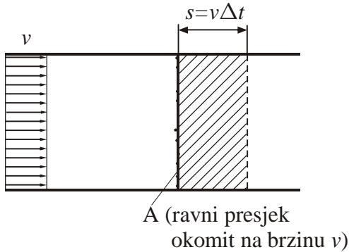
Čestice koje su u nekom trenutku bile u presjeku  $A$  će nakon vremena  $\Delta t$  prijeći put  $s = v\Delta t$ , i time opisati obujam  $\Delta V = A \cdot s = A v \Delta t$ . Protok je po definiciji
