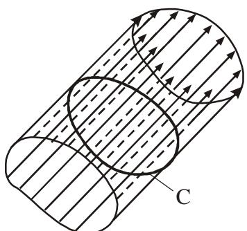
Kroz plašt strujne cijevi nema protoka, kao i kod fizičke cijevi!
