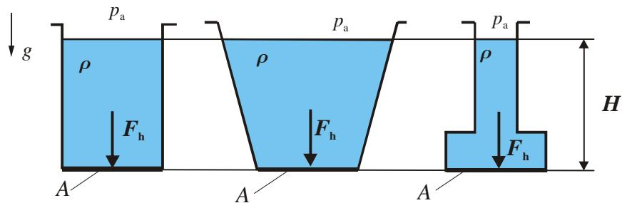
Sile hidrostatskog tlaka  $F_h = \rho g H A$  na dna svih posuda, prema slici, su jednake. Zapamtimo: u svim je slučajevima sila tlaka na dno posude jednaka težini fluida koji bi se nalazio u volumenu  $AH$  od dna posude do slobodne površine (bez obzira što u trećem slučaju toliko fluida niti nema u posudi).
