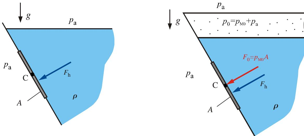
Položaj rezultantne sile  $F_R=F_h+F_0$  za slučaj istosmjernih i mimosmjernih sila  $F_0$  i  $F_h$ .
