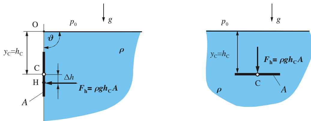
Hidrostatski paradoks: Sila tlaka na horizontalno dno posude zavisi od dubine fluida u posudi i ploštine dna posude, a ne zavisi o obliku posude
