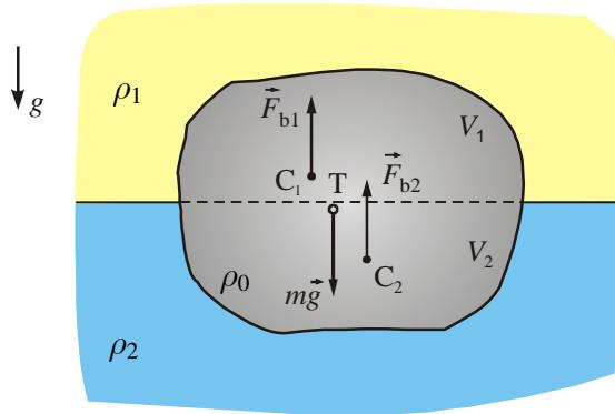
Sila  $F_b$  uzgona je zbroj  $F_b = F_{b1} + F_{b2} = \rho_1 g V_1 + \rho_2 g V_2$
