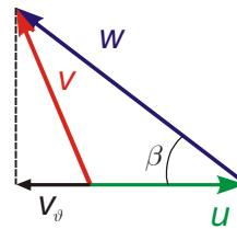
$$v_\vartheta = u - w \cos \beta \begin{cases} < 0 & \text{TURBINA} \\ = 0 & \text{slobodno rotirajuća cijev} \\ > 0 & \text{PUMPA} \end{cases}$$
