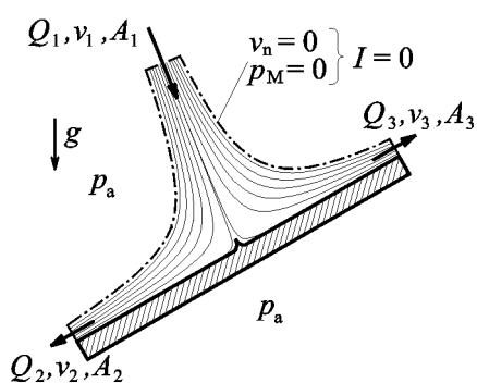
Slika prikazuje mlaz fluida površine poprečnog presjeka  $A_1$ , koji brzinom  $v_1$  i protokom  $Q_1 = v_1 A_1$ , nailazi na ravnu lopaticu (ploču jedinične širine) koja na sebi ima razdjelnik strujanja (nosić) kojim se mlaz dijeli na dvije grane označene indeksima 2 i 3. Ako je površina mlaza mala u odnosu na površinu lopatice mlaz će tangencijalno napuštati lopaticu. Mlaz struji u atmosferi, a s druge strane lopatice vlada atmosferski tlak.
