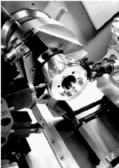
Slika 6.9. Radni prostor dvo-vretenog strgarskog centra sa slike 6.8.
