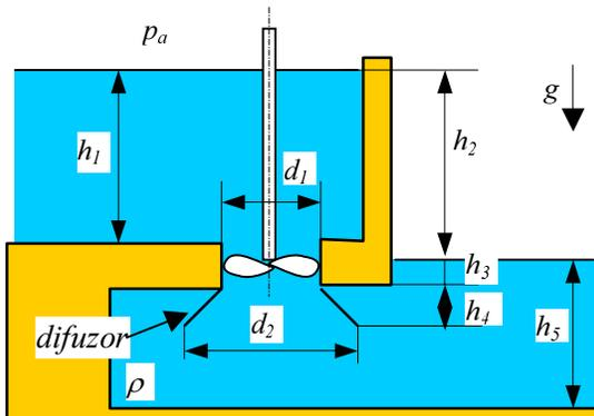
Između dva velika akumulacijska jezera ugrađena je brana s turbinom. Zbog povećanja stupnja djelovanja turbine ispod nje je montiran difuzor. Odredite silu na difuzor ako je izmjeren neto pad turbine  $h_t = 10.5$  m, Pretpostavite strujanje neviskozno fluida i jednolike profile brzina po svim presjecima. Zadano je:  $h_1 = 5.2$  m,  $h_2 = 12$  m,  $h_3 = 2.2$  m,  $h_4 = 0.9$  m,  $h_5 = 5.7$  m,  $d_1 = 1$  m,  $d_2 = 1.4$  m,  $\rho = 998$  kg/m<sup>3</sup>.
