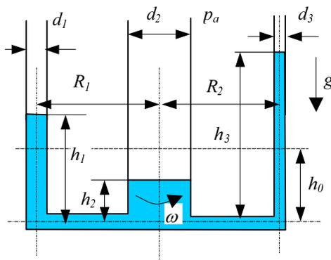
Tri cjevčice promjera  $d_1 = 10 \text{ mm}$ ,  $d_2 = 17 \text{ mm}$  i  $d_3 = 6 \text{ mm}$  ispunjene su tekućinom gustoće  $\rho = 998.2 \text{ kg/m}^3$  do visine  $h = 12 \text{ cm}$ . Odredite visine  $h_1$ ,  $h_2$  i  $h_3$  nakon što cjevčice zarotiramo konstantnom kutnom brzinom  $\omega = 25.6 \text{ rad/s}$ . Zadano je  $R_1 = 5 \text{ cm}$ ,  $R_2 = 12 \text{ cm}$ .
