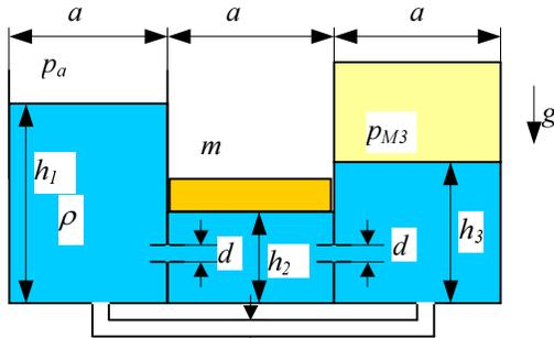
Odredite smjer strujanja i protok koji će se uspostaviti između tri rezervoara (jedinične širine) za situacije prema slici a i b. Pretpostavite da se visine nivoa u rezervoarima ne mijenja kada se uspostavi stacionarno strujanje. Zadano je:  $h_1 = 1.3 \text{ m}$ ,  $h_2 = 0.5 \text{ m}$ ,  $h_3 = 0.9 \text{ m}$ ,  $d = 12 \text{ mm}$ ,  $p_{M3} = 0.3 \text{ bara}$ ,  $m_{stap} = 23 \text{ kg}$ ,  $a = 0.75 \text{ m}$ ,  $\rho = 998 \text{ kg/m}^3$ .
