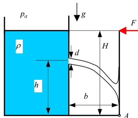
Iznos komponente brzine  $v_x$  se izračunava iz Torricellijeve formule
