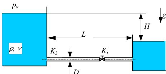
Izmjeren je protok kroz cjevovodni sistem prema slici od  $Q = 0.027 \text{ m}^3/\text{s}$ . Odredite visinu pješčane hrapavosti. Zadano je:  $H = 1.2 \text{ m}$ ,  $L = 12 \text{ m}$ ,  $D = 0.15 \text{ m}$ ,  $\rho = 1000 \text{ kg/m}^3$ ,  $K_1 = 7$ ,  $K_2 = 0.3$ ,  $\nu = 1.52 \cdot 10^{-6} \text{ m}^2/\text{s}$ .
