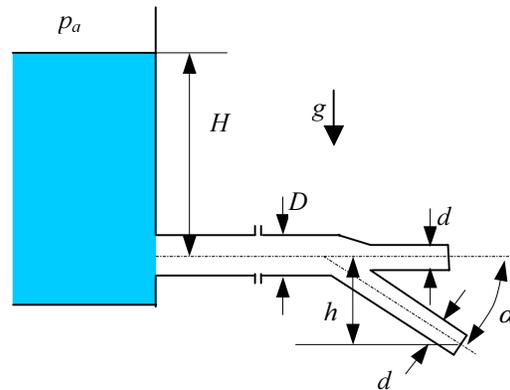
Iz Toricellyeve jednadžbe izračunavaju se brzine na izlaznim površinama
