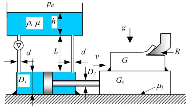
Iz zadane brzine gibanja obratka (stola i stapa) i uz upotrebu jednadžbe kontinuiteta moguće je izračunati brzine ispred i iza stapa te u privodnim kanalima promjera  $d$
