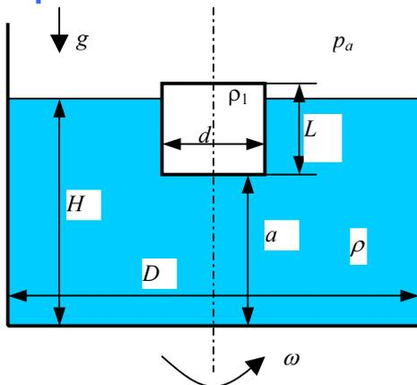
U cilindričnoj posudi promjera  $D = 0.22$  m ispunjenog vodom gustoće  $\rho = 999 \text{ kg/m}^3$  do visine  $H = 0.32$  m, pliva drveni valjak promjera  $d = 10$  cm, visine  $L = 4$  cm, gustoće drveta  $\rho_1 = 750 \text{ kg/m}^3$ . Odredite udaljenost  $a$  baze drvenog valjka od dna cilindrične posude nakon što posudu zarotiramo kutnom brzinom  $\omega = 7 \text{ rad/s}$ .
