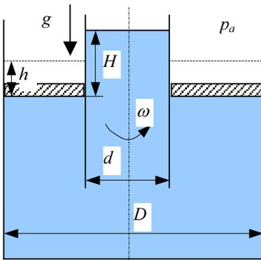
Odredite visinu  $h$  podizanja kružnog poklopca nakon što se posuda i fluid zarotiraju konstantnom kutnom brzinom  $\omega = 17 \text{ s}^{-1}$ . Zadano je:  $D = 23 \text{ cm}$ ,  $d = 12 \text{ cm}$ ,  $H = 5 \text{ cm}$ ,  $\rho = 998 \text{ kg/m}^3$ .
