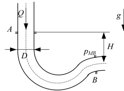
Da bi odredili silu  $F$  na luk AB potrebno je poznavati tlakove i brzine na presjecima A i B. Potrebno je postaviti Bernoullijevu jednadžbu i jednadžbu kontinuiteta
