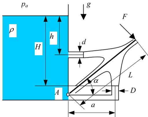
Odredite silu  $F$  koja pridržava ploču mase  $m_{ploce} = 64 \text{ kg}$  zglibno pričvršćenu u točki  $A$ . Pretpostavit neviskozno strujanje fluida te zanemarite težinu mlaza vode. Zadano je:  $L = 2.3\text{m}$ ,  $H = 7.4 \text{ m}$ ,  $h = 1.2 \text{ m}$ ,  $a = 0.75 \text{ m}$ ,  $D = 0.1 \text{ m}$ ,  $d = 5 \text{ cm}$ ,  $\alpha = 47^\circ$ ,  $\rho = 998.2 \text{ kg/m}^3$ .
