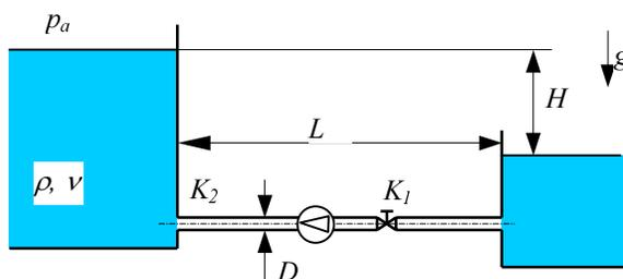
Pumpa visine dobave  $h_p = 32$  m, ostvaruje protok od  $Q = 3.2$  l/s kroz sistem prema slici. Odredite za koliko će se povećati protok kroz sistem ako ugradimo pumpu visine dobave  $h_{p1} = 46$  m uz nepromijenjene ostale veličine. Zadano je  $D = 0.12$  m (promjer cjevovoda),  $k = 0.015$  mm (visina hrapavosti cjevovoda),  $L = 1283$  m,  $H = 18$  m,  $\rho = 998.2$  kg/m<sup>3</sup>,  $\mu = 1.52 \cdot 10^{-3}$  Pas.
