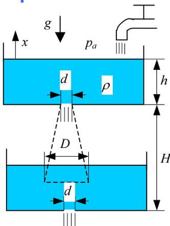
Odredite promjenu visine  $x$  nivoa fluida u gornjem spremniku ako na izlazni otvor gornjeg spremnika pričvrsti difuzor prema slici. Pretpostavite strujanje idealnog fluida. Zadano je:  $H = 1.6 \text{ m}$ ,  $d = 1.2 \text{ cm}$ ,  $D = 2 \text{ cm}$ ,  $h = 1.43 \text{ m}$ ,  $\rho = 998.2 \text{ kg/m}^3$ .
