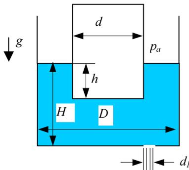
Odredite vrijeme potrebno da se potpuno isprazni cilindrična posuda promjera  $D = 72$  cm u kojoj pliva valjak promjera  $d = 23$  cm prema slici. Pretpostavite nevizkozno strujanje fluida. Zadano je:  $d_1 = 13$  mm,  $H = 1.2$  m,  $h = 45$  cm.
