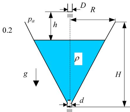
Odredite silu  $F$  na lijevak prema slici. Pretpostavite stacionarno neviskozno strujanje fluida te zanemarite težinu lijevka. Zadano je:  $Q = \text{lit/s}$ ,  $D = 0.05 \text{ m}$ ,  $d = 0.011 \text{ m}$ ,  $H = 27 \text{ cm}$ ,  $R = 11 \text{ cm}$ ,  $h \cong 0$ ,  $\rho = 1000 \text{ kg/m}^3$ .
