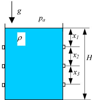
Tankostijena valjkasta bačva potpuno je ispunjena vodom gustoće  $\rho = 998.2 \text{ kg/m}^3$  do visine  $H = 2.3 \text{ m}$ , prema slici. Zbog povećanja krutosti stijenke potrebno je ugraditi tri ojačanja. Odredite položaje ojačanja  $x_1$ ,  $x_2$  i  $x_3$  tako da je svako ojačanje opterećeno jednakom silom.
