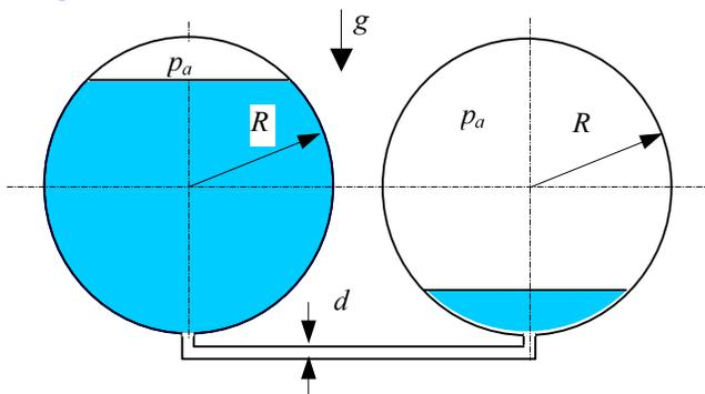
Odredite vrijeme potrebno da se razina u oba kuglasta spremnika izjednači. U početnom trenutku lijevi spremnik je bio potpuno pun, a desni potpuno prazan. Pretpostavite kvazistacionarno strujanje idealnog fluida te potpuno ispunjenu prelivnu cijev u početnom trenutku. Zadano je:  $R = 2 \text{ m}$ ,  $d = 0.12 \text{ m}$ .
