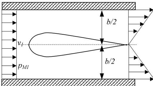
Sila otpora profila avionskog krila jedinične širine mjeri se u zračnom tunelu širine  $b = 1.2$  m. Odredite silu na profil ako su na presjecima 1 i 2 snimljeni profili brzine prema slici. Pretpostavite konstantan tlak na svakom vertikalnom presjeku. Zadao je:  $\rho = 1.2 \text{ kg/m}^3$ ,  $p_{MI} = 0.25 \text{ bar}$ ,  $v_1 = 10 \text{ m/s}$ .
