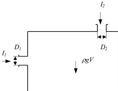
Da bi se izračunala sila na filtar potrebno je izračunati tlakove i brzine na presjecima 1 i 2.
