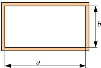
Klimatizacijski vod pravokutnog poprečnog presjeka  $a \times b = 40 \times 30$  cm zbog rekonstrukcije prostorije potrebno je zamijeniti klimatizacionim vodom pravokutnog poprečnog presjeka čija visina nije veća od  $b_I = 17$  cm. Odredi širinu klimatizacionog voda koja osigurava jednaki pad tlaka po jedinici duljini, pri istom protoku. Pretpostavite strujanje u režimu potpune turbulencije. Zadano je:  $k = 0.15$  mm (visina hrapavosti).
