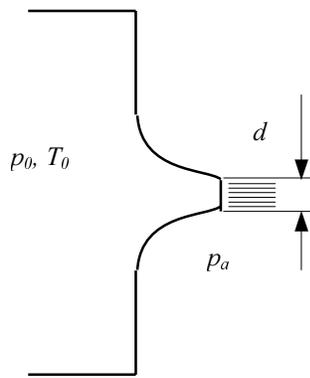
Zrak ( $R = 287.05 \text{ J/kgK}$ ,  $\kappa = 1.4$ ) izentropski struji kroz konvergentnu sapnicu u atmosferu. Odredite maseni protok  $q_{\text{maseni}}$  ako je izlazni promjer sapnice  $d = 12 \text{ mm}$ . Zadano je:  $p_0 = 2.3 \text{ bar}$ ,  $T_0 = 430 \text{ K}$ ,  $p_a = 1.013 \text{ bar}$ .
