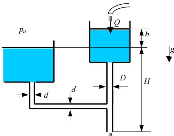
Odredite visinu  $h$  nivoa u spremniku koji će se uspostaviti u stacionarnom režimu strujanja. Pretpostavite strujanje neviskoznog fluida. Zadano je:  $Q = 0.0052 \text{ m}^3/\text{s}$ ,  $H = 0.8 \text{ m}$ ,  $D = 0.03 \text{ m}$ ,  $d = 0.02 \text{ m}$ .
