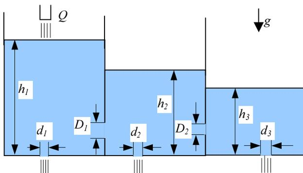
Odredite promjere  $D_1$  i  $D_2$  otvora između spremnika, prema slici, da bi protok iz sva tri spremnika bio isti. Pretpostavite nevizkozno stacionarno strujanje fluida. Zadano je:  $Q = 1.2 \text{ l/s}$ ,  $d_1 = 12 \text{ mm}$ ,  $d_2 = 17 \text{ mm}$ ,  $d_3 = 22 \text{ mm}$ .
