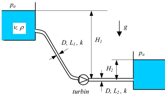
Bernoullijeva jednačba od površine lijevog do površine desnog spremnika
