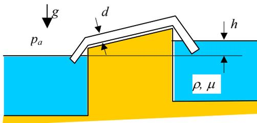
Voda ( $\rho = 998.2 \text{ kg/m}^3$ ,  $\mu = 10^{-3} \text{ Pas}$ ) preljeva se sifonom iz jednog jezera za navodnjavanje u drugo, prema slici, kroz cijev promjera  $d = 50 \text{ mm}$ . Ukupna duljina cijevi je  $L = 1.8 \text{ m}$ , a visina hrapavosti je  $k = 0.20 \text{ mm}$ . Lokalni gubitak u koljenu  $K_k = 0.4$ . Odredite protok vode kroz cijev. Zadano je:  $h = 0.13 \text{ m}$
