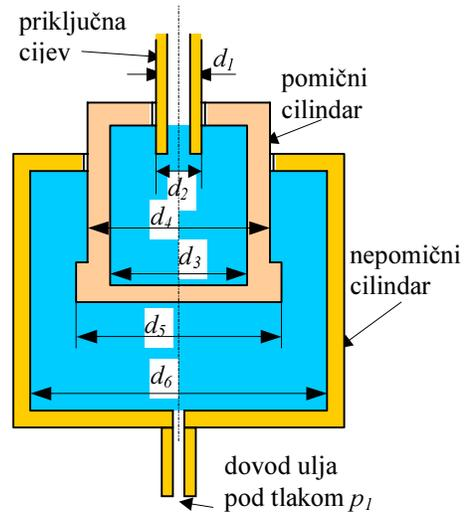
Suma sila na pomični cilindar mora biti jednaka nuli. Sila  $p_2(d_3^2 - d_2^2)\pi/4$  djeluje na dno pomičnog cilindra ali i na vrh cilindra pa se te dvije sile međusobno poništavaju. Pretpostavlja se da je visina cilindra mala pa je razlika tlaka izmjeđu vrha i dna cilindra zanemriva.
