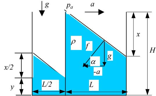
Nakon što nastupi jednoliko ubrzano gibanje akceleracijom  $a$  dio fluida prelije se preko pregrade AB u desni dio spremnika, prema slici. Poznavajući akceleraciju  $a$  moguće je izračunati nagib vode u kolicima nakon što nastupi jednoliko ubrzano gibanje
