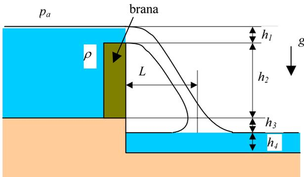
Odredite horizontalnu silu na branu jedinične širine prema slici. Pretpostavite strujanje idealnog fluida, te uniformne profile brzina dovoljno daleko od brane i na preljevu. Zadano je:  $h_1 = 0.1$  m,  $h_2 = 1.2$  m,  $h_3 = 0.25$  m,  $h_4 = 0.6$  m,  $L = 0.35$  m,  $\rho = 1000$  kg/m<sup>3</sup>.
