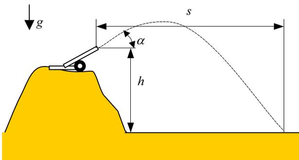
Domet topovskog zrna  $s$  ovisi o početnoj brzini zrna  $v_0$ , kutu topovske cijevi  $\alpha$ , visina brda  $h$  i gravitaciji  $g$ . Primjeno dimenzijske analize odredite bezdimenzijske  $\pi$  parametre te nađite zavisnost tih bezdimenzijskih parametara  $F(\pi_1, \pi_2, \dots)$  pomoću jednadžbe kosog hica.
