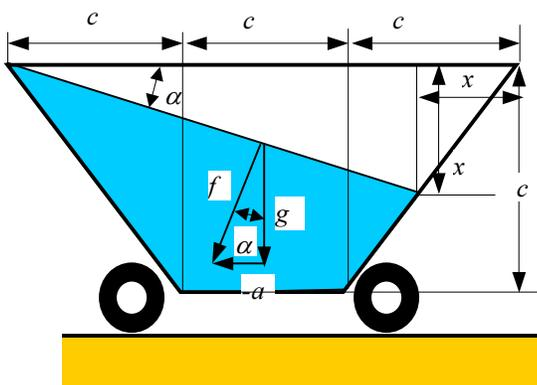
U kolicima se nalazi identičan volumen vode prije i poslije ubrzavanja akceleracijom  $a$  (uvjet da ne dođe do prelijevanja). Međutim ni količina zraka u kolicima se ne mijenja tokom ubrzavanja. Volumen zraka  $V_0$  je trapezna prizma sa stranicama  $3c$  i  $2c$  te visinom baze  $c/2$ .
