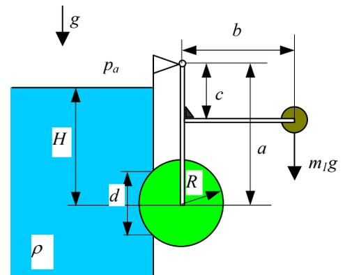
Rezultantna sila na kuglasti zatvarač prema slici može se rastaviti na dvije komponente (horizontalnu i vertikalnu). Rezultantna sila prolazi kroz težište kugle (detaljnije objašnjenje uz zadatak 24.06.1998.). Iz slike je vidljivo da vertikalna komponenta sile ne čini nikakav moment sa zglobom već samo horizontalna. Ako postavimo jednačbe za horizontalnu komponentu sile hidrostatskog tlaka i sumu momenata oko zgloba
