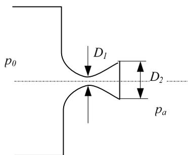
Kroz konvergentno – divergentnu sapnicu zrak ( $R = 287 \text{ J/kgK}$ ,  $\kappa = 1.4$ ) izentropski istječe u atmosferu masenim protokom  $q_{\text{maseni}} = 1.94 \text{ kg/m}^3$ . Ako u spremniku vlada tlak  $p_0 = 3.2 \text{ bara}$  odredite promjer  $D_2$  izlaznog presjeka pravilno proširene sapnice. Zadano je:  $p_a = 1013 \text{ mbar}$ ,  $D_1 = 100 \text{ mm}$
