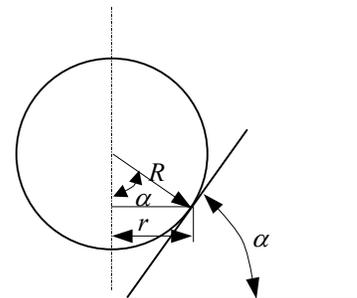
Iz ravnoteže sila u vertikalnom smjeru sila pritiska potrebna za otvaranje sigurnosnog ventila na slici jednaka je zbroju težine kuglice i sile u opruzi.
