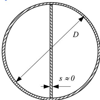
Oredite koliko puta se smanji protok kroz cijev okruglog presjeka uz isti pad tlaka po jediničnoj duljini cijevi ako se cijev pregradi vertikalnom stjenkom. Pretpostavite laminarno strujanje te beskonačno tanku pregradu. Strujanje se odvija u oba pregrađena dijela cijevi.
