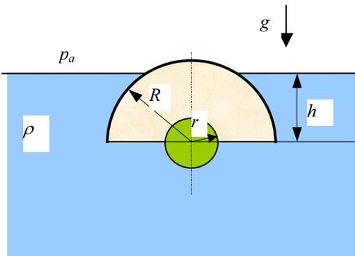
Odredite masu  $m_p$  polukuglaste posude koja je uronjena do dubine  $h = 0.38 \text{ m}$ . Unutar polukuglaste posude pliva kugla promjera  $r = 0.23 \text{ m}$  prema slici. Zanemarite debljinu stijenke polukuglaste posude. Zadano je:  $R = 41 \text{ cm}$ ,  $\rho = 998 \text{ kg/m}^3$ .
