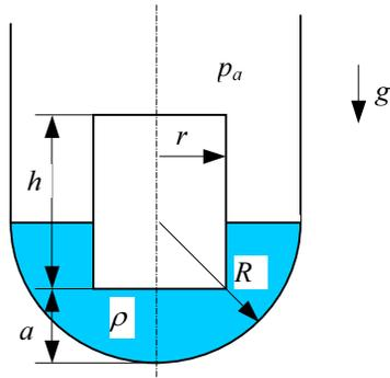
U polukuglastoj posudi ispunjenoj vodom gustoće  $\rho = 998.2 \text{ kg/m}^3$  pliva valjak mase  $m_{\text{valjka}} = 33 \text{ kg}$ . Koliko iznosi udaljenost  $a$  između dna posude i valjka, kada se posuda zarotira konstantnom kutnom brzinom  $\omega = 3 \text{ s}^{-1}$ . Zadano je.  $R = 0.4 \text{ m}$ ,  $r = 0.2 \text{ m}$ ,  $h = 0.35 \text{ m}$ .
