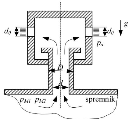
U slučaju zatvorenog ventila tlak u spremniku djeluje na kružnoj površini promjera  $d$ . Kod otvaranja sila pretlaka mora savladati težinu zatvarača ventila.
