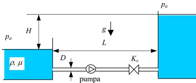
Odredite radnu točku pumpe (visinu dobave  $h_p$  i protok  $Q_p$ ) za situaciju prema slici. Karakteristika pumpe zadana je sljedećim izrazom  $\{h_p\}_m = 12 - 10^5 \cdot \{Q\}_{m^3/s}^2$ . Gubitak na ulazu u cjevovod zanemarite. Zadano je:  $H = 9$  m,  $L = 23$  m,  $D = 0.05$  m,  $k = 0.1$  mm (hrapavost cijevi),  $K_v = 3$ ,  $\rho = 998$  kg/m<sup>3</sup>,  $\mu = 1.52 \cdot 10^{-3}$  Pas.
