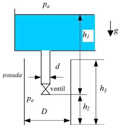
Odredite vrijeme, mjereno od otvaranja ventila, potrebno da se napuni posuda prema slici. Pretpostavite kvazistacionarno strujanje neviskoznog fluida. U proračunu je potrebno uzeti u obzir debljinu cijevi  $d$ . Zadano je:  $h_1 = 1.8 \text{ m} = \text{const.}$ ,  $d = 25 \text{ mm}$ ,  $h_2 = 30 \text{ cm}$ ,  $h_3 = 100 \text{ cm}$ ,  $D = 80 \text{ cm}$ .
