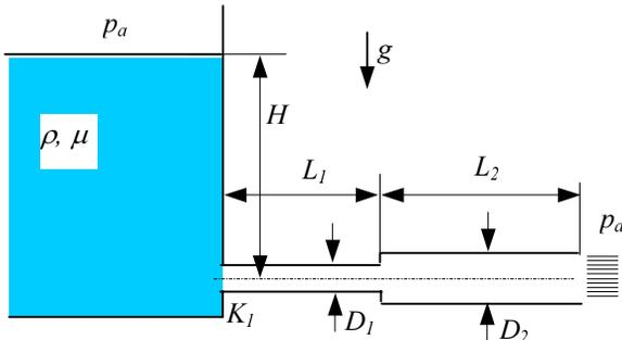
Iz rezervoara s konstantnim nivoom visine  $H = 9$  m, istječe voda gustoće  $\rho = 998,2$  kg/m<sup>3</sup> viskoznosti  $\mu = 10^{-3}$  Pas kroz horizontalnu cijev od trgovačkog čelika. Odredite izlazni promjer cijevi  $D_2$  da se uspostavi protok  $Q = 0.06$  m<sup>3</sup>/s. Zadano je:  $L_1 = 120$  m,  $L_2 = 260$  m,  $D_1 = 150$  mm,  $K_1 = 0.5$ .
