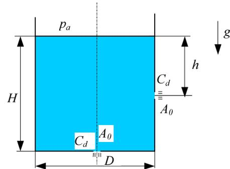
Iz jednadžbe kontinuiteta količina fluida koja je istekla kroz otvor jednaka je smanjenju volumena unutar posude. Brzinu na izlaznom presjeku računamo iz Torricellijeve jednadžbe. Za slučaj otvora na plaštu posude vrijeme pražnjenja računamo prema izrazima (Ishodište koordinatnog sustava potrebno je postaviti u visini otvora kroz koji istječe fluid).
