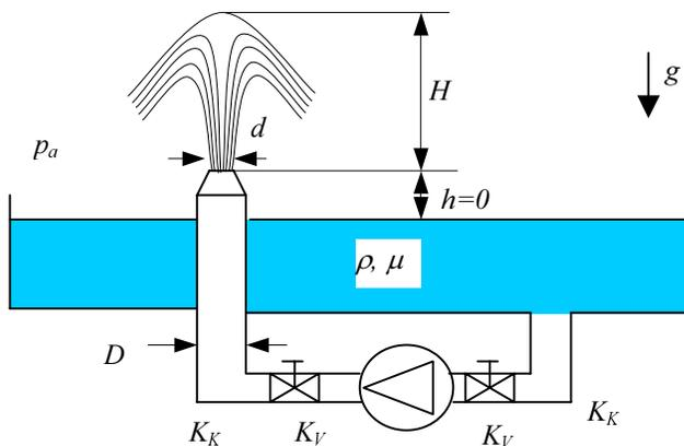
Odredite radnu točku pumpe (visinu dobave i protok) da bi visina mlaza vode ( $\rho = 998.2 \text{ kg/m}^3$ ,  $\mu = 1.52 \cdot 10^{-3} \text{ Pas}$ ) vodoskoka bila  $H = 3.4 \text{ m}$ . Zadano je:  $K_K = 2.7$ ,  $K_V = 4.5$ ,  $K_S = 1.2$  (lokalni gubitak sapnice izražen uz veću brzinu),  $L = 7.2 \text{ m}$  (ukupna duljina svih cijevi)  $D = 0.3 \text{ m}$  (promjer svih cijevi). Pretpostavite da su sve cijevi iz trgovačkog čelika. Zadano je:  $d = 0.1 \text{ m}$ .
