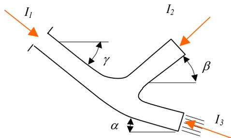
Sila  $F$  jednaka je impulsnoj funkciji  $I_2$ . Iz jednadžbe količine gibanja za ravnu ploču moguće je izračunati brzinu strujanja  $v_2$
