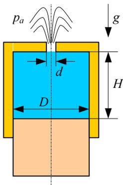
Odredite vrijeme potrebno da se cilindrična kapa, mase  $m_k = 7$  kg, spusti na stup promjera  $D = 20$  cm. Zanemarite trenje između kape i stupa, te pretpostavite savršeno brtvljenje. Zadano je:  $d = 2$  mm,  $c_d = 0.8$ ,  $H = 17$  cm,  $\rho = 998$  kg/m<sup>3</sup>.
