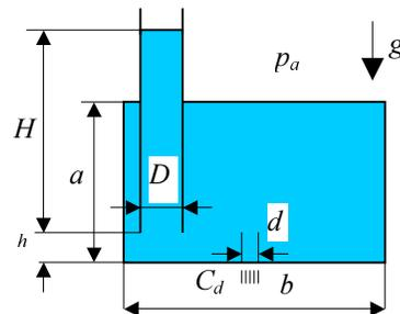
Kvazistacionarno istjecanje fluida iz spremnika sa slobodnom površinom konstantnom s promjenom visine, računa se prema izrazu
