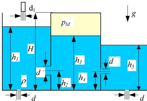
Odredite visine  $h_1$ ,  $h_3$  i  $h_5$  unutar spremnika prema slici koje se uspostave pri stacionarnom strujanju protokom  $Q = 30$  l/s. Pretpostavite izotermnu kompresiju zraka u srednjem spremniku. Zadano je:  $p_a = 1.013$  bar,  $H = 1$  m,  $\rho = 1000$  kg/m<sup>3</sup>,  $h_2 = 0.18$  m,  $h_4 = 0.18$  m,  $d = 75.6$  mm,  $d_1 = 100$  mm.
