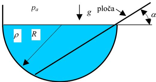
U horizontalno postavljenom kružnom cilindru jedinične širine ispunjenog vodom ( $\rho = 998.2 \text{ kg/m}^3$ ) postavljena je pravokutna ploča jedinične širine. Pri kojem kutu  $\alpha$  se hvatište hidrostatske sile na gornju površinu ploče nalazi na najvećoj dubini i pri kojem kutu  $\alpha_1$  sila hidrostatskog tlaka na gornju površinu ploče poprima maksimalnu vrijednost. Zadano je:  $R = 1.2 \text{ m}$ .
