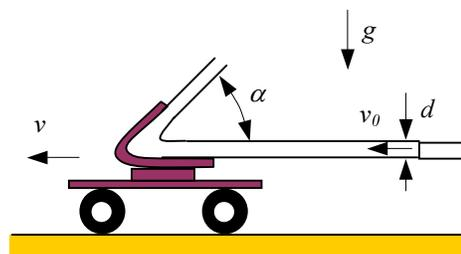
Pri rješenju ovog zadatka potrebno je uvesti pomični koordinatni sustav koji se giba sa kolicima brzinom  $v$ . Relativna brzina  $w$  nastrojavanja fluida na lopaticu jednaka je  $w = v_0 - v$ . Iz jednadžbe ravnoteže sila (sila otpora jednaka je sili dobivenoj iz jednadžbe količine gibanja u relativnom sustavu)
