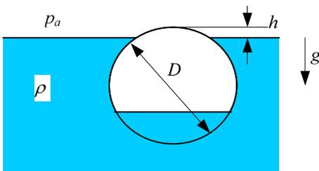
Odredite masu valjka  $m_{valjka}$  (jedinične širine), ako je visina h valjka koja se nalazi iznad površine vode  $h = 0.18 \text{ m}$ . Valjak promjera  $D = 72 \text{ cm}$ , ispunjen je do jedne trećine volumena vodom gustoće  $\rho = 998 \text{ kg/m}^3$ .
