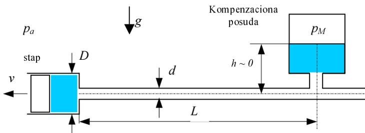
Odredite minimalni potrebni pretlak  $p_M$  u kompenzacionoj posudi koji osigurava da klip savladava silu  $F = 70 \text{ N}$  pri brzini gibanja klipa  $v = 120 \text{ mm/min}$ . Sve lokalne gubitke zanemarite. Zadao je:  $D = 24 \text{ mm}$ ,  $d = 10 \text{ mm}$ ,  $L = 74 \text{ m}$ ,  $\rho = 956.1 \text{ kg/m}^3$ ,  $\mu = 0.65 \text{ Pas}$  (ulje).
