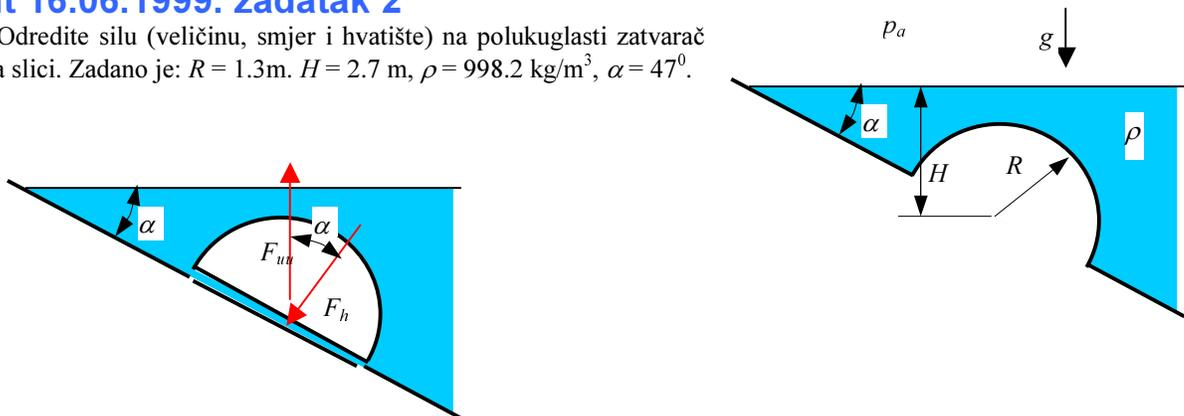
Sila na polukuglasti zatvarač može se zamijeniti sa dvije sile, silom hidrostatskog tlaka  $F_h$  na ravnu površinu i uzgonskom silom na polovinu kugle  $F_u$  (prema slici)
