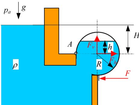
Vertikalna komponenta sile na sekciju BC jednaka je umnošku pretlaka i projekcije površine
