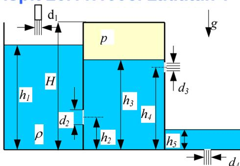
Odredite visine  $h_1$ ,  $h_3$  i  $h_5$  unutar spremnika prema slici koje se uspostave pri stacionarnom strujanju protokom  $Q = 9.42 \text{ l/s}$ . Pretpostavite izotermnu kompresiju zraka u srednjem spremniku. Zadano je:  $p_a = 1.013 \text{ bar}$ ,  $H = 1 \text{ m}$ ,  $\rho = 1000 \text{ kg/m}^3$ ,  $h_2 = 0.28 \text{ m}$ ,  $h_4 = 0.49 \text{ m}$ ,  $d_1 = 0.1 \text{ m}$ ,  $d_2 = 75.6 \text{ mm}$ ,  $d_3 = 92.6 \text{ mm}$ ,  $d_4 = 72.2 \text{ mm}$ .
