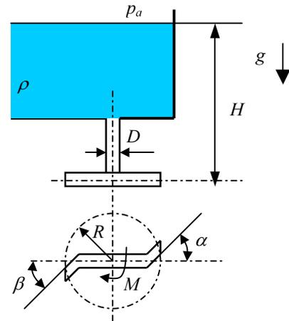
Brzina strujanja na izlaznim presjecima lako se računa prema Torricellijevoj jednadžbi
