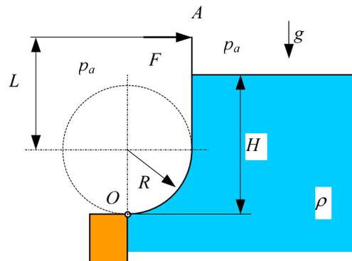
Pregradu OA potrebno je podijeliti u dva segmenta prvi ravna ploča, a drugi četvrt plašta valjka. Sila hidrostatskog tlaka, na četvrt plašta valjka, prolazi kroz središte valjka jer svaka diferencijalna sila na plaštu valjka prolazi središtem valjka pa i rezultantna sila prolazi središtem (detaljnije objašnjenje uz zadatak 24.06.1998.).
