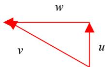
Iz trokuta brzina očito je da je obodna komponenta apsolutne brzine jednaka obodnoj brzini
