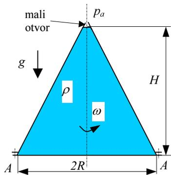
Posuda oblika stošca rotira oko vertikalne osi konstantnom kutnom brzinom  $\omega$ . Odredite kutnu brzinu  $\omega$  tako da bi sila na vijke A bila tri puta veća od sile u slučaju kada posuda ne rotira. Zadano je:  $\rho = 998.2 \text{ kg/m}^3$ ,  $R = 1.2 \text{ m}$ ,  $H = 1.45 \text{ m}$ .
