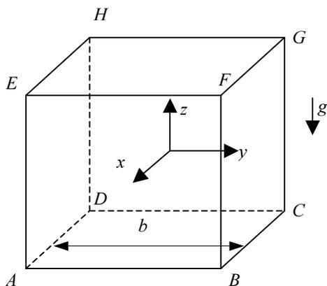
Odredite akceleraciju  $a$  (po smjeru i veličini) kockastog spremnika, prema slici, ispunjenog fluidom gustoće  $\rho = 998.2 \text{ kg/m}^3$  ako su zadane razlike tlakova na prostornim dijagonalama. Zadano je:  $\Delta p_{AG} = 2.3 \text{ bar}$ ,  $\Delta p_{BH} = 1.4 \text{ bar}$ ,  $\Delta p_{CE} = 3.1 \text{ bar}$ ,  $b = 4.2 \text{ m}$ .
