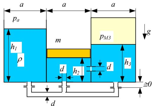
Za određivanje smjerova strujanja u sistemu, potrebno je odrediti piezometarske visine u tri spremnika
