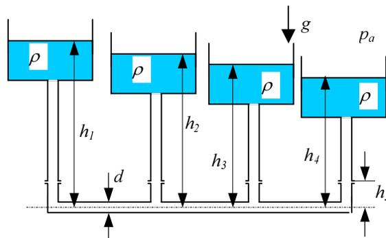
$$v_2 = \sqrt{2 \cdot g \cdot (h_1 - h_2)} \quad v_3 = \sqrt{2 \cdot g \cdot (h_1 - h_3)} \quad v_4 = \sqrt{2 \cdot g \cdot (h_1 - h_4)}$$
