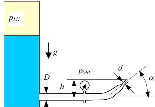
Iz uvjeta da manometar pokazuje pretlak  $p_{M0} = 3.2$  bar, za zatvorenu mlaznicu moguće je odrediti totalni pretlak u spremniku (totalni pretlak uključuje i visinu vode u spremniku), koji je jednak  $p_{M0} = 3.2$  bar. Pomoću Bernoullijeve jednadžbe od spremnika do ulaza u mlaznicu moguće je odrediti brzinu na ulazu u mlaznicu.
