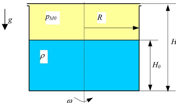
Poklopac na cilindričnoj posudi u mirovanju, prema slici, pridržava se podtlakom  $p_{M0} = 0.001$  bar u posudi. Pri kojoj kutnoj brzini rotacije  $\omega$  će se poklopac otvoriti. Zadano je  $H = 2.6$  m,  $H_0 = 1.8$  m,  $R = 1$  m,  $\rho = 998.2$  kg/m<sup>3</sup>.
