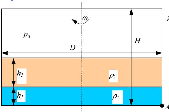
U cilindričnoj posudi promjera  $D = 2.4$  m i visine  $H = 1.25$  m nalaze se dva fluida različite gustoće. Posuda je ispunjena vodom gustoće  $\rho_1 = 999$  kg/m<sup>3</sup> do visine  $h_1 = 0.32$  m te uljem gustoće  $\rho_2 = 830$  kg/m<sup>3</sup> do visine  $h_2 = 0.17$  m. Odredite pretlak u točki A nakon što posudu zarotiramo kutnom brzinom  $\omega = 3.8$  rad/s.
