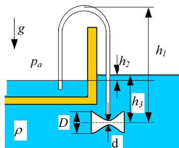
Iza krmenog zrcala čamca pričvršćen je venturimetar da bi crpio vodu (gustoće  $\rho = 999.2$  kg/m<sup>3</sup>) iz čamca. Odredite minimalnu brzinu čamca kod koje započinje crpenje vode (prazna priključna cijev) te minimalnu brzinu kod koje je crpenje još uvijek moguće (puna priključna cijev). Zadano je:  $h_1 = 0.85$  m,  $h_2 = 0.13$  m,  $h_3 = 0.21$  m,  $D = 4$  cm,  $d = 1$  cm.
