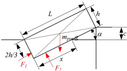
Iz geometrijskih odnosa potrebno je odrediti kut nagiba pontona  $\alpha$  te duljinu uranjanja  $x$ .
