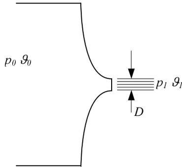
Pri izentropskom istjecanju zraka ( $\kappa = 1.4$ ,  $R = 287 \text{ J/kgK}$ ) iz spremnika kroz konvergentnu sapnicu promjera  $D = 50 \text{ mm}$  izmjeren je maseni protok  $q_{\text{maseni}} = 0.5 \text{ kg/s}$ . Odredite tlak i temperaturu u spremniku, ako je temperatura izlaznog mlaza  $\vartheta = 20^\circ\text{C}$ , a tlak  $p_1 = 1.01 \text{ bar}$ .
