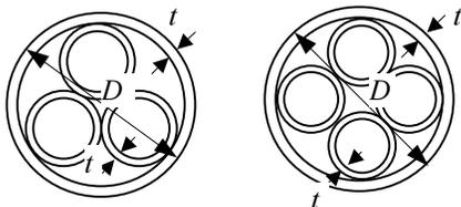
Unutar zaštitne cijevi vanjskog promjera  $D = 1.5$  m potrebno je postaviti tri odnosno četiri cijevi, prema slici, dimenzionirane tako da se dotiču. Odredite odnos protoka za isti pad tlaka po jedinici duljine u oba slučaja. Pretpostavite da su sve stijenke cijevi debljine  $t = 1.2$  cm, te pretpostavite strujanje u laminarnom režimu.
