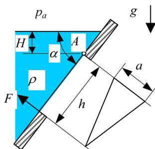
Odredite silu  $F$  potrebnu za otvaranje poklopca prema slici zgloбно vezanog u A. Poklopac je oblika jednakokraknog trokuta visine  $h = 0.65$  m, i baze  $a = 0.28$  m. Zadano je:  $H = 0.3$  m,  $\alpha = 23^\circ$ ,  $\rho = 998.2 \text{ kg/m}^3$
