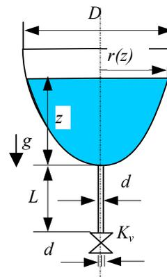
Posuda je oblika rotacionog paraboloida pa vrijedi izraz  $z - L = ar^2$ . Konstantu  $a$  određujemo pomoću rubnih uvjeta
