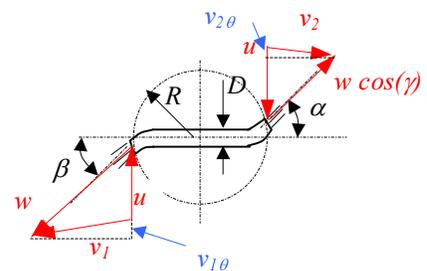
Bernoullijeva jednadžba za rotirajuću strujnu cijev
