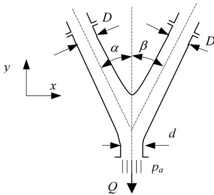
Odredite  $F_y$  komponentu sile na račvu koja se nalazi u horizontalnoj ravnini, prema slici, ako je  $F_x$  komponenta sile jednaka nuli. Zadano je  $Q = 20.8$  l/s,  $\rho = 998$  kg/m<sup>3</sup>,  $\alpha = 26^\circ$ ,  $\beta = 35^\circ$ ,  $d = 100$  mm,  $D = 130$  mm.
