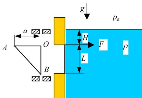
Trokutasti poklopac AOB uležišten je i okretljiv oko brida OB prema slici. Sila  $F$  djeluje s hvatištem u točki A u smjeru okomitom na poklopac. Kolika je veličina sile  $F$  potrebna za držanje poklopca u ravnotežnom položaju. Zadano je:  $\rho = 998 \text{ kg/m}^3$ ,  $H = 1 \text{ m}$ ,  $a = 2 \text{ m}$ ,  $L = 3 \text{ m}$ .
