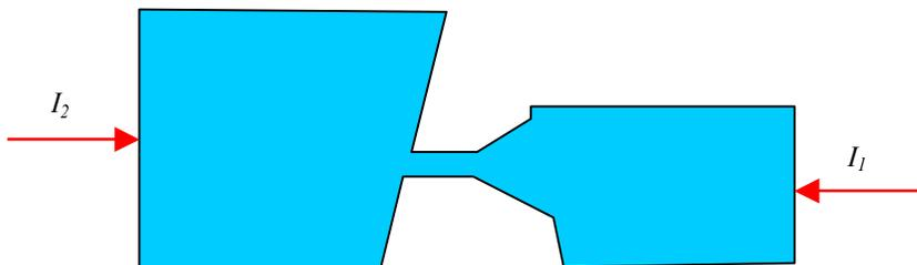
$$I_1 = \left( \rho \cdot g \cdot \frac{H}{2} + \rho \cdot v_1^2 \right) L \cdot H \quad I_2 = \left( \rho \cdot g \cdot \frac{h}{2} + \rho \cdot v_2^2 \right) L \cdot h$$
