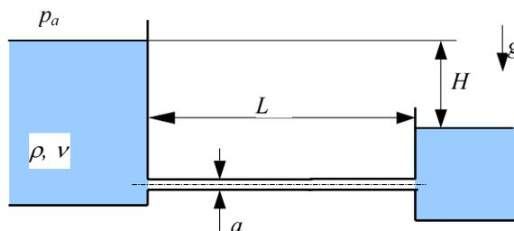
Modificirana Bernoullijeva jednadžba za slučaj strujanja kroz cijev kvadratnog poprečnog presjeka
