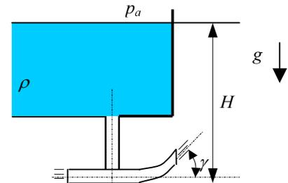
Da bi sistem prema slici rotirao kao slobodno rotirajuća cijev snaga razvijane na jednom kraju (kraj cijevi u pumpnom režimu rada) troši se za rotaciju drugog kraja cijevi (kraj cijevi u turbinskom režimu rada).
