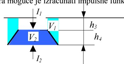
Sila hidrostatskog tlaka s vanjske strane difuzora jednaka je težini vode koja zauzima prostor između difuzora i slobodne površine. Silu uslijed gibanja fluida može se izračunati pomoću impulsnih funkcija
