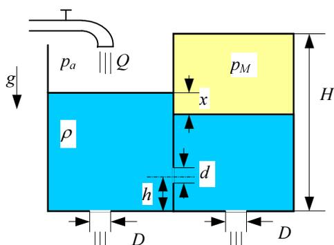
Odredite razliku  $x$  nivoa vode gustoće  $\rho = 1000 \text{ kg/m}^3$  u rezervoarima nakon što se uspostavi stacionarno strujanje. U početnom trenutku oba rezervoara su bila prazna. Pretpostavite strujanje idealnog fluida te izotermnu kompresiju zraka u desnom rezervoaru. Zadano je:  $D = 4 \text{ cm}$ ,  $d = 2 \text{ cm}$ ,  $Q = 7 \text{ l/s}$ ,  $H = 2 \text{ m}$ ,  $h = 0.3 \text{ m}$ ,  $p_a = 1.013 \text{ bara}$ .
