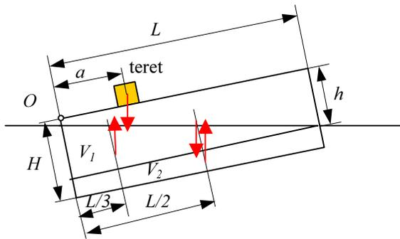
Volumen pontona koji se nalazi ispod površine vode podijeljen je u volumene  $V_1$  i  $V_2$
