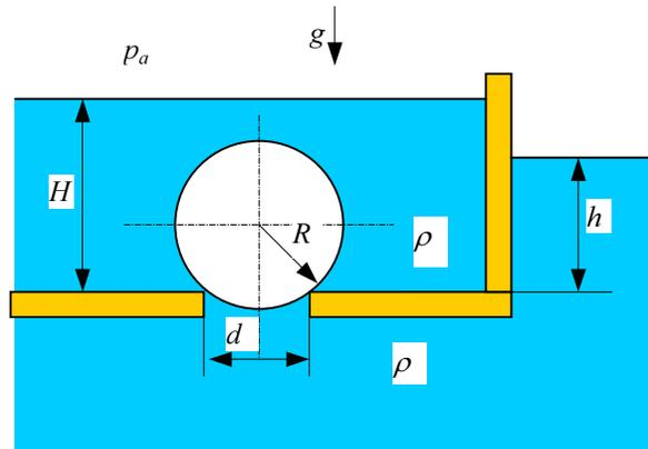
Sila hidrostatskog tlaka na kuglu računa se parcijalno za površine  $S_1$ ,  $S_2$  i  $S_3$ .
