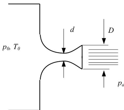
Zrak ( $R = 287 \text{ J/kgK}$ ,  $\kappa = 1.4$ ) izentropski struji pravilno proširenu konvergentno – divergentnu sapnicu (tlak u izlaznom mlazu jednak je atmosferskom tlaku). Odredite maseni protok i izlazni promjer  $D$  ako je promjer grla  $d = 12\text{mm}$ , a brzina u izlaznom mlazu  $M = 2$  Mach. Zadano je:  $p_a = 1.013 \text{ bar}$ ,  $T_0 = 337 \text{ K}$ .
