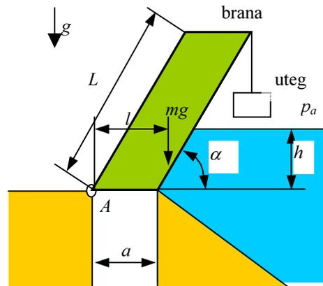
Sila hidrostatskog tlaka je okomita na površinu i djeluje ispod težišta površine (Na slici je prikazan vrlo čest slučaj kada se površina proteže do slobodne nivo površine (dubina u smjeru površine  $y$ ). Za takve slučajeve hvatište sile
