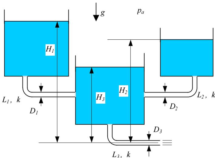
Odredite promjer  $D_3$  cijevi iz uvjeta da se razina  $H_3$  vode ( $\rho = 998.2 \text{ kg/m}^3$ ,  $\nu = 1.139 \cdot 10^{-5} \text{ m}^2/\text{s}$ ) unutar spremnika 3 na mijenja. Zadano je:  $H_1 = 47 \text{ m}$ ,  $H_2 = 35 \text{ m}$ ,  $H_3 = 27 \text{ m}$ ,  $D_1 = 0.23 \text{ m}$ ,  $D_2 = 0.15 \text{ m}$ ,  $k = 0.01 \text{ mm}$  (hrapavost svih cijevi),  $L_1 = 23 \text{ m}$ ,  $L_2 = 58 \text{ m}$ ,  $L_3 = 78 \text{ m}$ .
