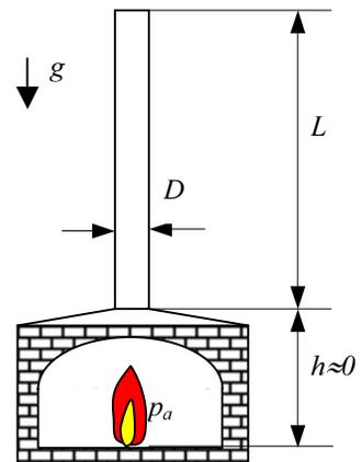
Prema uvjetima zadatka potrebno je uzeti u obzir razliku atmosferskog tlaka između vrha dimnjaka i ložišta. Atmosferski tlak  $p_{aD}$  na visini vrha dimnjaka računa se iz jednadžbe manometra.
