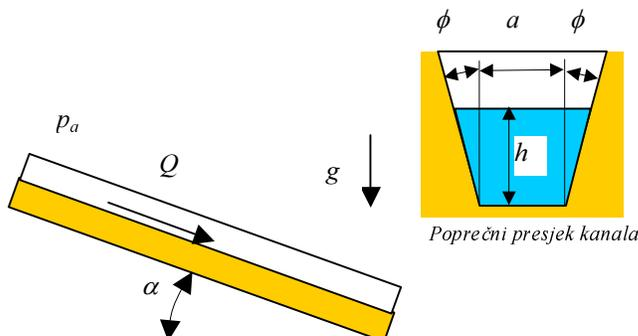
Za potrebe navodnjavanja potrebno je dobavljati  $Q = 2.3 \text{ m}^3/\text{s}$  otvorenim kanalom u obliku trapeza prema slici. Odredite nagib kanala  $\alpha$  ako je visina vode u kanalu  $h = 0.3 \text{ m}$ . Pretpostavite strujanje u režimu potpune turbulencije te da je kanal izgrađen od betona visine hrapavosti  $k = 1 \text{ mm}$ . Zadano je:  $\phi = 23^\circ$ ,  $a = 0.75 \text{ m}$ .
