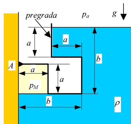
Horizontalne i vertikalne komponente sile na pregradu računaju se prema izrazima
