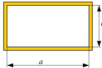
Poprečni presjek klimatizacijskog voda je pravokutan pa je potrebno uvesti ekvivalentan promjer
