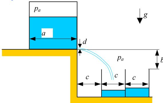
Odredite količinu fluida u spremnicima 1, 2 i 3 nakon pražnjenja kockastog spremnika stranice  $a = 1$  m, kroz otvor promjera  $d = 3$  cm na dnu spremnika prema slici te da je na početku spremnik bio potpuno ispunjen fluidom. Pretpostavite neviskozno strujanje fluida. Zadano je:  $b = 2.3$  m,  $c = 0.7$  m.
