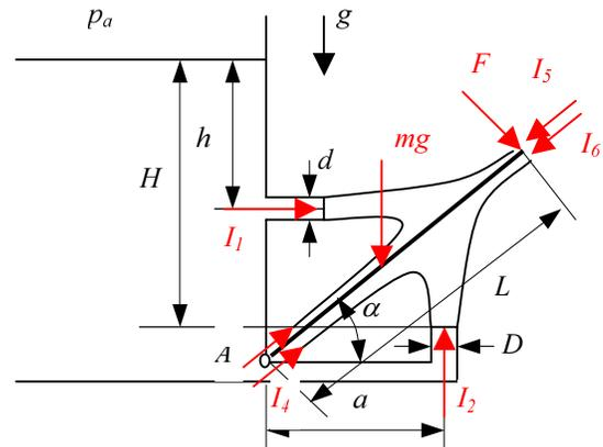
Na ploču sljedeće sile: sila težine ploče  $mg$ , sila  $F$  te sile mlaza vode predstavljene impulsnim funkcijama  $I_1$  do  $I_6$ . Brzine mlaza vode računa se iz Toricellyeve jednadžbe
