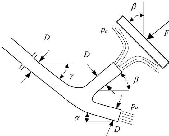
U horizontalnoj ravnini nalazi se dvokraka račva prema slici. Odredite silu fluida na račvu ako je sila mlaza na ravnu ploču  $F = 384 \text{ N}$ . Pretpostavite neviskozno strujanje fluida. Zadano je:  $D = 150 \text{ mm}$ ,  $\rho = 1000 \text{ kg/m}^3$ ,  $\alpha = 25^\circ$ ,  $\beta = 37^\circ$ ,  $\gamma = 42^\circ$ .
