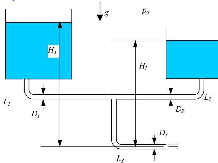
Odredite visinu  $H_2$  za sistem prema slici, ako je protok kroz cijev  $L_1$  dva puta veći od protoka kroz cijev  $L_2$ . Pretpostavite konstantan koeficijent trenja  $\lambda$  u svim cijevima  $\lambda = 0.023$ . Zadano je:  $H_1 = 23$  m,  $D_1 = 120$  mm,  $L_1 = 230$  m,  $D_2 = 100$  mm,  $L_2 = 270$  m,  $D_3 = 150$  mm,  $L_3 = 720$  m,  $\rho = 998.2$  kg/m<sup>3</sup>,  $\nu = 1.52 \cdot 10^{-6}$  m<sup>2</sup>/s.
