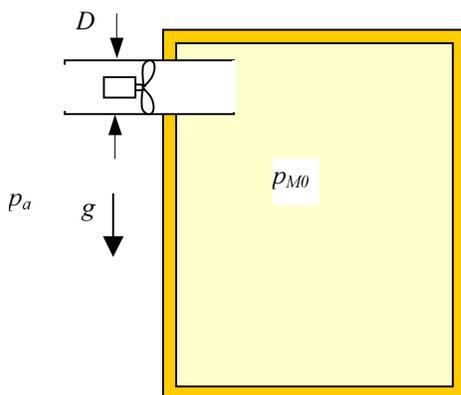
Odredite aksijalnu silu na ventilator koji ubacuje svježi zrak gustoće  $\rho = 1.14 \text{ kg/m}^3$  protokom  $Q = 0.3 \text{ m}^3/\text{s}$  u prostoriju. Pretpostavite nevizkozno strujanje fluida. Zadano je:  $D = 200 \text{ mm}$ ,  $p_{M0} = 100 \text{ Pa}$  (pretlak u prostoriji).
