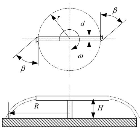
Odredite domet  $R$  mlaza poljevača trave koji se okreće kutnom brzinom  $\omega = 7.96 \text{ rad/s}$  bez trenja u ležajevima. Zadano je:  $r = 27 \text{ cm}$ ,  $\beta = 42^\circ$ ,  $H = 0.93 \text{ m}$
