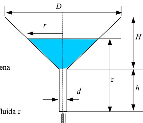
Gubitak fluida unutar lijevka jednak je protoku u jedinici vremena
