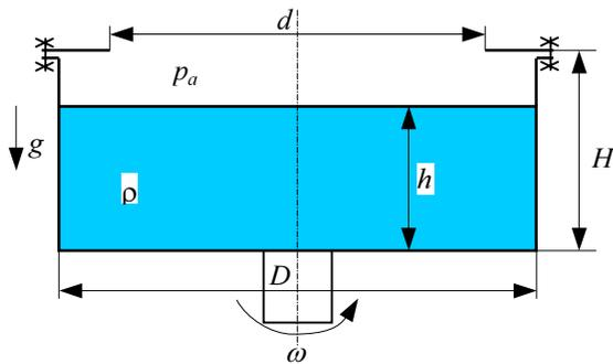
Odredite silu na poklopac cilindrične posude prema slici, koja je prije rotacija bila ispunjena vodom gustoće  $\rho = 998 \text{ kg/m}^3$  do visine  $h = 6.9 \text{ cm}$ . Nakon rotacije u posudi ostane polovica prvobitnog volumena vode. Zadano je:  $D = 10 \text{ cm}$ ,  $d = 8 \text{ cm}$ ,  $H = 7.8 \text{ cm}$ .
