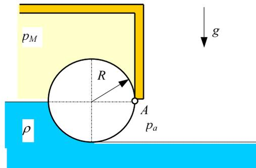
Na slici su prikazane sile koje djeluju na valjak na gornju polovicu valjka (zeleno na slici) djeluje sila konstantnog potlaka, na donju četvrtinu valjka (plavo na slici) djeluju vertikalna i horizontalna sila hidrostatskog tlaka te u središtu valjka djeluje sila težine.
