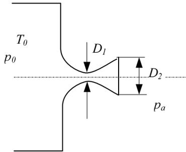
Kroz konvergentno divergentnu sapnicu zrak ( $R = 287 \text{ J/kgK}$ ,  $\alpha = 1.4$ ) istječe u atmosferu. Odredite maseni protok kroz pravilno proširenu sapnicu prema slici. Zadano je:  $D_1 = 5 \text{ mm}$ ,  $p_0 = 4 \text{ bara}$ ,  $p_a = 1.013 \text{ bara}$ ,  $T_0 = 302 \text{ K}$ .
