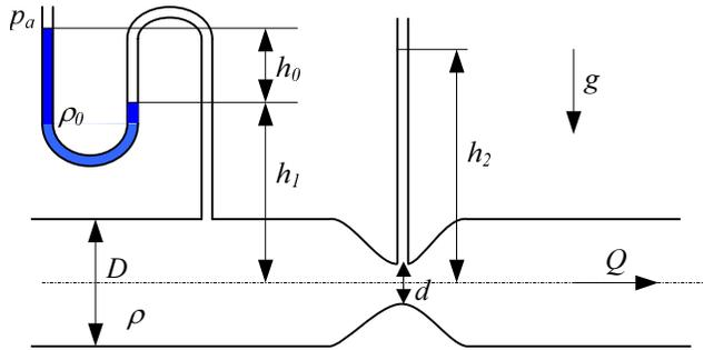
Izračunajte protok  $Q$  kroz cijev prema slici uz pretpostavku da je koeficijent protoka  $C_d = 0.98$ . Zadano je:  $D = 200$  mm,  $d = 150$  mm,  $h_1 = 38$  cm,  $h_2 = 65$  cm,  $h_0 = 5.2$  cm,  $\rho_0 = 13560$  kg/m<sup>3</sup>,  $\rho = 1000$  kg/m<sup>3</sup>.
