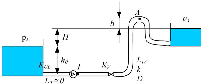
Odredite koliki je minimalni pretlak u sistemu prema slici ukoliko je izmjeren maksimalni pretlak u sistemu  $p_M = 7$  bara. Zadano je:  $\rho = 999,1 \text{ kg/m}^3$ ,  $\nu = 1,05 \cdot 10^{-6} \text{ m}^2/\text{s}$ ,  $H = 20 \text{ m}$ ,  $h = 2 \text{ m}$ ,  $h_0 = 1 \text{ m}$ ,  $L_{IA} = 90 \text{ m}$ ,  $D = 250 \text{ mm}$ ,  $L_{uk} = 250 \text{ m}$ ,  $k = 0.045 \text{ mm}$  (hrapavost cijevi),  $K_{UL} = 2$ ,  $K_V = 5$ .
