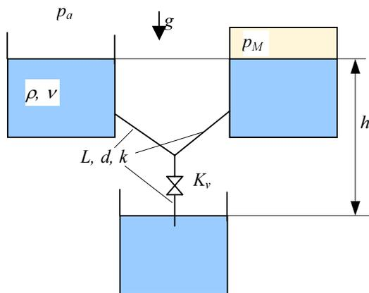
Odredite koeficijent otpora ventila  $K_v$  pri kome će protok u grani s ventilom biti  $Q_3 = 9$  l/s. Zadano je  $L = 9$  m,  $d = 0.05$  m,  $k = 0.015$  mm, (sve tri cijevi su iste duljine, promjera i visine hrapavosti)  $h = 15$  m,  $p_M = 0.15$  bar,  $\rho = 998$  kg/m<sup>3</sup>,  $\nu = 1.52 \cdot 10^{-6}$  m<sup>2</sup>/s.
