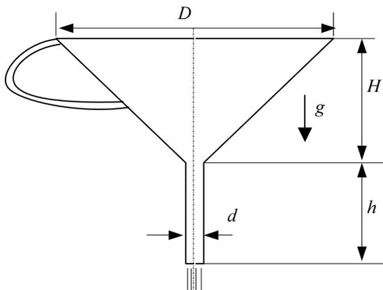
Odredite vrijeme potrebno za pražnjenje lijevka (traktura) prema slici. Pretpostavite kvazistacionarno strujanje neviskoznog fluida. Zanemarite vrijeme potrebno da se isprazni cjevčica promjera  $d$ . Zadano je:  $D = 20$  cm,  $d = 0.5$  cm,  $H = 17$  cm,  $h = 12$  cm.
