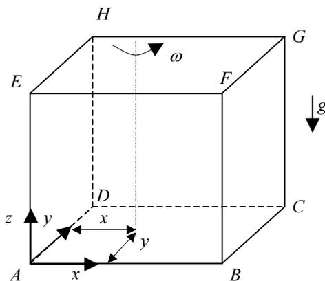
Odredite položaj vertikalne osi oko koje kockasti spremnik, prema slici, rotira konstantnom kutnom brzinom  $\omega = 2.3 \text{ rad/s}$ . Spremnik je ispunjen fluidom gustoće  $\rho = 998.2 \text{ kg/m}^3$ . Zadano je:  $\Delta p_{AC} = 1250 \text{ Pa}$ ,  $\Delta p_{BD} = 2050 \text{ Pa}$ ,  $b = 4.2 \text{ m}$ .
