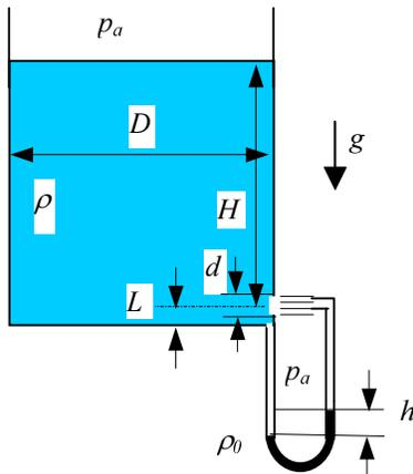
Odredite vrijeme  $t$  pražnjenja cilindričnog spremnika promjera  $D = 23$  cm, ako je očitavanje na manometru iznosi  $h = 0.067z$  ( $z$  je visina vode u spremniku) i na mijenja se tijekom pražnjenja spremnika. Pretpostavite kvazistacionarno strujanje fluida. Zadano je:  $H = 1.2$  m,  $d = 12$  mm,  $\rho = 998$  kg/m<sup>3</sup>,  $\rho_0 = 13570$  kg/m<sup>3</sup>,  $L \approx 0$ ,  $c_c = 1$  (koeficijent kontrakcije mlaza).
