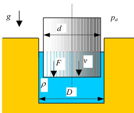
Odredite kojom silom  $F$  treba opteretiti klip promjera  $d = 5$  cm, da bi se spuštao brzinom  $v = 1.2$  m/s u cilindru promjera  $D = 6$  cm, ispunjenog vodom gustoće  $\rho = 998.2$  kg/m<sup>3</sup>. Pretpostavite strujanje idealnog fluida. Uputa: koordinatni sustav postavite relativno u odnosu na klip.
