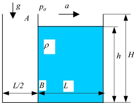
Odredite silu  $F$  na pregradu kolica  $\overline{AB}$  jedinične širine koja se ubrzavaju udesno konstantnom akceleracijom  $a = 7.2 \text{ m/s}^2$ . Zadano je:  $H = 1.2 \text{ m}$ ,  $h = 1.06 \text{ m}$ ,  $L = 0.6 \text{ m}$ ,  $\rho = 998.2 \text{ kg/m}^3$ .
