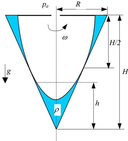
Vertikalni stožac visine  $H = 45 \text{ cm}$  i polumjera baze  $R = 27 \text{ cm}$ , ispunjen vodom gustoće  $\rho = 998.2 \text{ kg/m}^3$  rotira kutnom brzinom  $\omega$ . Odredite do koje visine  $h$  je stožac bio ispunjen vodom prije rotacije, ako tijekom rotacije slobodna površina tangira plašt stošca na visini  $H/2$ , prema slici.
