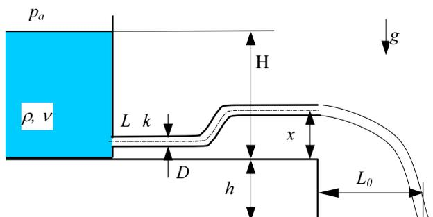
Odredite maksimalni domet  $L_0$  mlaza vode ( $\rho = 998.2 \text{ kg/m}^3$ ,  $\nu = 1.04 \cdot 10^{-6} \text{ m}^2/\text{s}$ ). Kraj cijevi postavljen je horizontalno na visini  $x$ . Sve lokalne gubitke zanemarite. Radi jednostavnijeg proračuna pretpostavite strujanje u režimu potpune turbulencije. Zadano je:  $D = 0.3 \text{ m}$ ,  $L = 23 \text{ m}$ ,  $k = 0.015 \text{ mm}$  (visina hrapavosti cijevi),  $h = 1.2 \text{ m}$ ,  $H = 3.7 \text{ m}$ .
