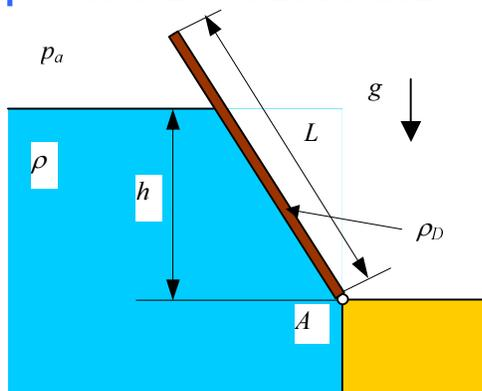
Odredite maksimalnu visinu  $h$  razine fluida gustoće  $\rho = 998.2 \text{ kg/m}^3$  da ne dođe do prevrtanja drvene pregrade, jedinične širine, zglobno vezane u točki A. Zadano je:  $L = 1.2 \text{ m}$ ,  $\rho_D = 750 \text{ kg/m}^3$ ,  $d = 2 \text{ cm}$  (debljina drvene pregrade).
