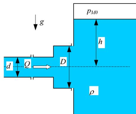
Bernoullijeva jednačba od ulazne cijevi do površine spremnika pod tlakom
