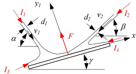
Prema uvjetu zadatka pretpostavlja se strujanje neviskoznog fluida pa se na ploču ne može prenijeti sila u smjeru koordinate  $x_1$ . Sila  $F$  mora biti okomita na ploču. Jednadžba količine gibanja dana je izrazom
