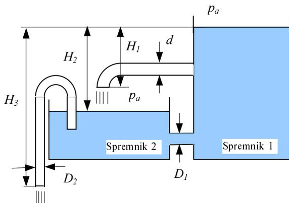
Odredite promjer  $d$  cjevovoda prema slici da bi nivo u spremniku 2 ostao na istoj visini. Pretpostavite neviskozno strujanje fluida. Pretpostavite konstantnu visinu u spremniku 1. Zadano je:  $H_1 = 0.65$  m,  $H_2 = 1.2$  m,  $H_3 = 3.6$  m,  $D_1 = 100$  mm,  $D_2 = 250$  mm.
