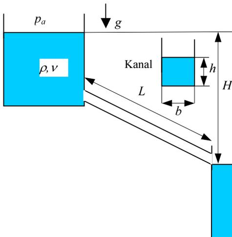
Voda gustoće  $\rho = 999 \text{ kg/m}^3$  se pretače iz višeg u niži spremnik kroz pravokutni betonski kanal širine  $b = 0.23 \text{ m}$ , duljine  $L = 730 \text{ m}$  protokom  $Q = 7 \text{ l/s}$ . Odredite visinu  $h$  vode u kanalu. Sve lokalne gubitke zanemarite. Zadano je:  $H = 25 \text{ m}$ ,  $\nu = 1.52 \cdot 10^{-6} \text{ m}^2/\text{s}$  (viskoznost vode),  $k = 1 \text{ mm}$  (visina hrapavosti za beton).
