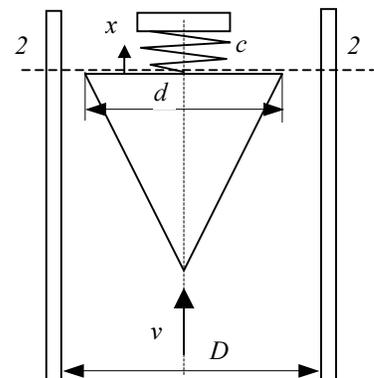
Iz jednačbe kontinuiteta računa se brzina na presjeku 2-2
