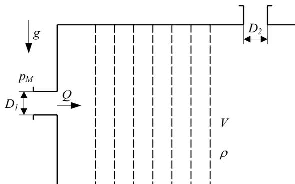
Brzinu strujanja na ulaznom i izlaznom presjeku iz filtra računamo iz jednadžbe kontinuiteta
