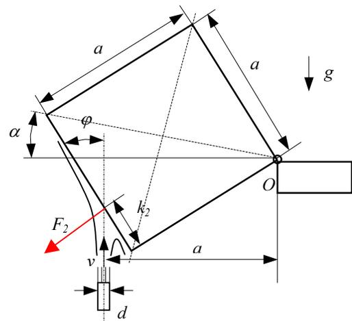
Kako je riječ o neviskoznom strujanju nemoguće je prenijeti tangencijalnu komponentu sile na površinu. Prema tome sile  $F_1$  i  $F_2$  moraju biti okomite na površine (prema slikama). Impulsne funkcije dijela mlaza nakon sudara s kockom nikako ne sudjeluju u normalnoj komponenti sile (nalaze se u ravnini okomitoj na silu). Impulsna funkcija mlaza jednaka je
