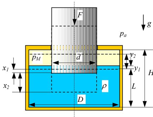
Kod sastavljanja amortizera (klip taman začepi otvor promjera  $d$ ) u amortizeru se nalazi volumen  $V_0$  na atmosferskom tlaku
