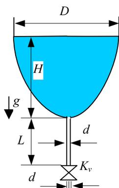
Odredite vrijeme  $t$  pražnjenja spremnika oblika rotacionog paraboloida, prema slici. Pretpostavite kvazistacionarno viskozno strujanje fluida te da je koeficijent trenja  $\lambda$  konstantan i da iznosi  $\lambda = 0.02$ . Zadano je  $H = 2.31 \text{ m}$ ,  $L = 7 \text{ m}$ ,  $K_v = 3$ ,  $d = 0.015 \text{ m}$ ,  $D = 1.6 \text{ m}$ .
