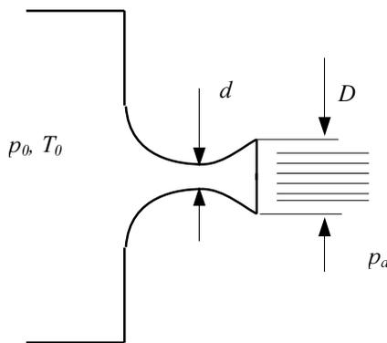
Odredite izlazni promjer  $D$  pravilno proširene konvergentno – divergentne sapnice kroz koju izotropski struji zrak ( $R = 287 \text{ J/kgK}$ ,  $\kappa = 1.4$ ). Zadano je:  $p_0 = 2.98 \text{ bar}$ ,  $p_a = 1.013 \text{ bar}$ ,  $T_0 = 437 \text{ K}$ ,  $d = 12 \text{ mm}$ .
