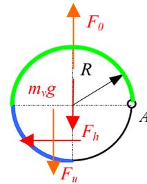
Unutar plave regije valjka sve diferencijalne sile djeluju u smjeru tlaka (tj. okomito na površinu). Kako niti jedna diferencijalna sila ne radi moment s centrom valjka niti rezultantna sila ne smije raditi moment s centrom valjka. Prema tome komponente sile hidrostatskog tlaka pomičemo u centar valjka (detaljnije objašnjenje uz zadatak 24.06.1998.). Suma momenata oko točke A jednaka je
