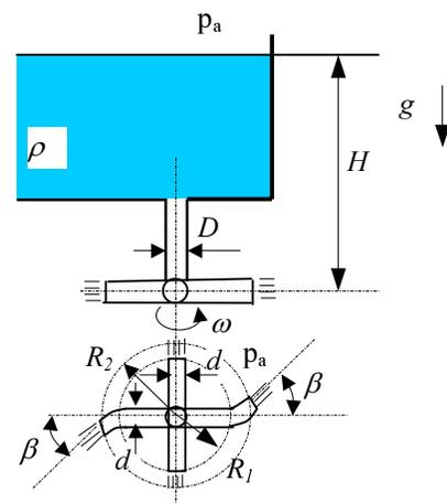
Postavljanjem Bernoullijeve jednačbe za rotirajuću strujnu cijev od slobodne površine do svakog od izlaza iz četverokrake rotirajuće cijevi moguće je izračunati relativne brzine na izlazima iz cijevi.
