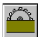
Da bi kreirali operaciju urezivanja utora pomoću kružne testere potrebno je kliknuti na ikonu priказанu lijevo. Odmah nakon toga u donjem dijelu ekrana će se prikazati forma za unos parametara operacije, kao što je prikazano na slici ispod.
