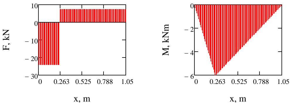
Maksimalni moment savijanja (po intenzitetu):  $M_{\max} := M(L_1) = -6 \cdot \text{kN} \cdot \text{m}$
