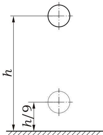
3. Kuglica mase  $m$  pusti se sa visine  $h$  da padne na horizontalnu podlogu. Koeficijent sudara između kuglice i podloge je  $k = \frac{1}{\sqrt{3}}$ . Nakon koliko udara će se kuglica popeti na visinu jednaku  $h/9$  uz pretpostavku da su svi udari normalni. Zanemariti otpor zraka.
